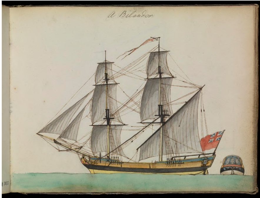
Figura 10. “Bilander británico que muestra velas y aparejos y vista separada de la popa” (c. 1780). (Dibujo de Edward Gwyn, © National Maritime Museum, Greenwich, Londres).
